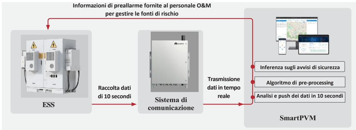
Figura 19 Processo di preallarme di sicurezza
