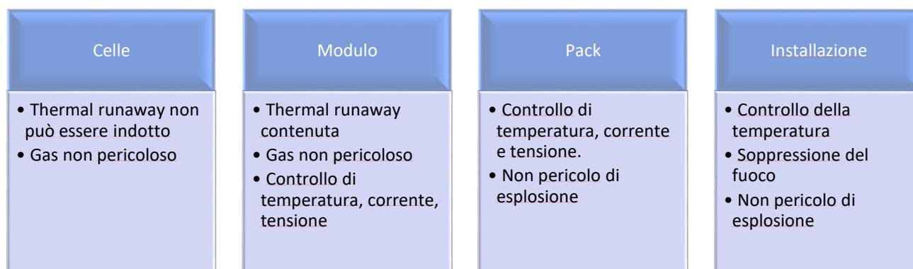
Figura 12 Sequenza di Test per UL 9540A
